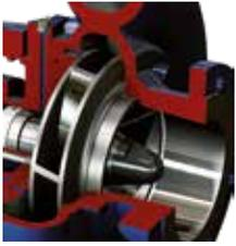
**OGNI GRANDEZZA HA UN SOLO CORPO** che può essere utilizzato per la girante chiusa (con collare d'usura) e girante aperta (con piastra di usura sostituibile). Questo consente, con semplici operazioni, di adattare la pompa a nuove esigenze d'impianto e processo.
