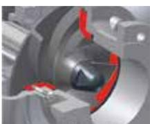
La **PIASTRA DI USURA SOSTITUIBILE** garantisce lunga vita alla pompa e riduce i costi di manutenzione. Inoltre il supporto è dotato di **REGISTRAZIONE ASSIALE** dei GIOCHI che possono essere variati operando da lato comando.
